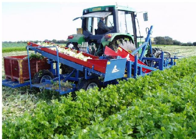
図 9. セロリの機械収穫 (GRIMMER より引用)
