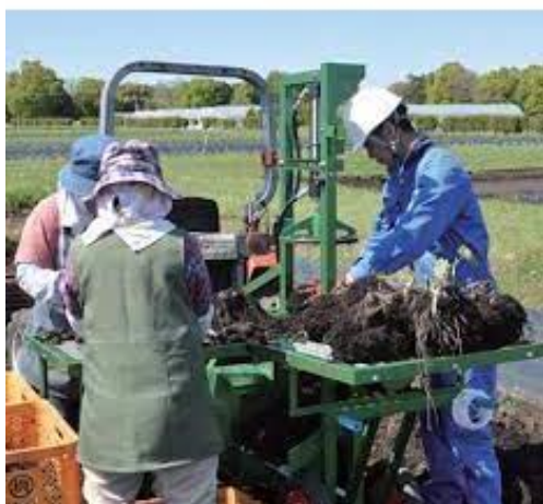
図 9. 子芋分離機による親芋と子芋の分離作業 (クボタより引用)
