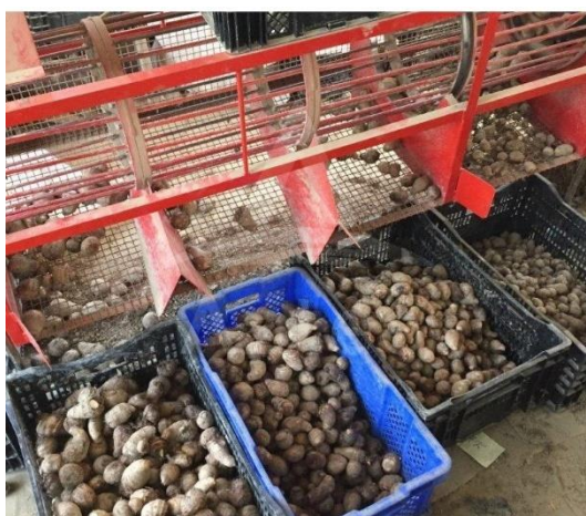
図 11. 篩分け機によるサトイモのサイズ分け (ホクエツより引用)
