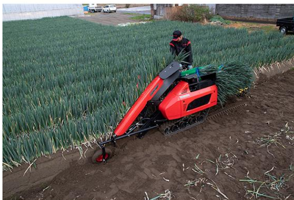
図8. 長ねぎの機械収穫（井関農機より引用）
