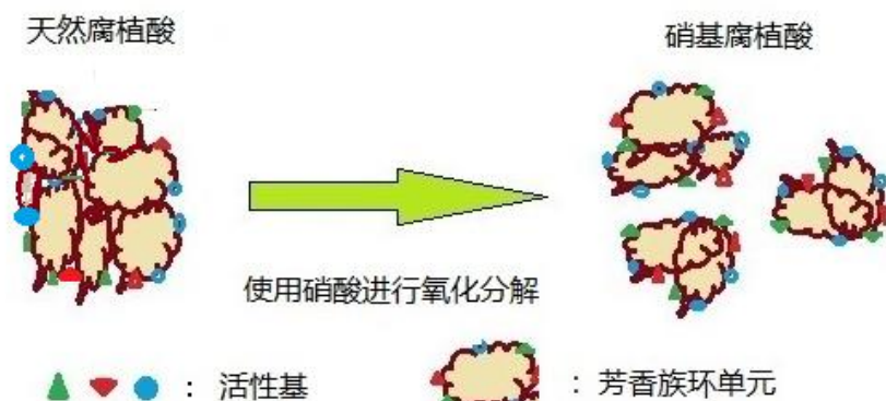
图 1. 使用硝酸进行氧化分解天然腐植酸生成硝基腐植酸的示意图
