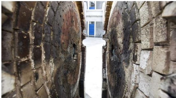
图 4. 放电设备内部的电极固定圆盘（表面残迹是放电痕迹）
