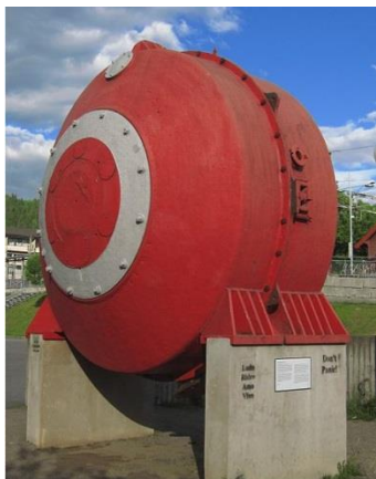
图 3. 固氮用的放电设备
