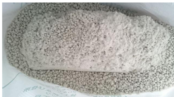
图 2. 因重压造成的挤压硫酸铵颗粒结块
