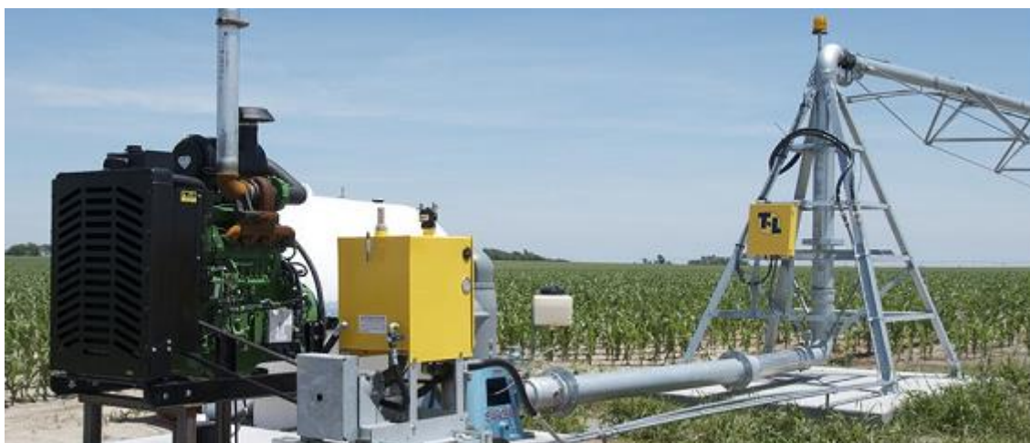
图 3. 中心枢纽灌溉系统的供水系统（使用内燃机发电，用电力从灌井中抽水和压送到洒水器）
