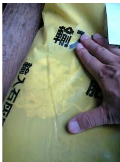
图 2. 石灰氮包装工序中混入的塑料绳 (包装材料的残留物)
