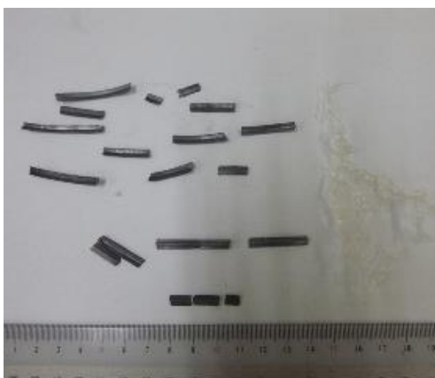
图 1. 在球状硝酸钾生产工程混入的金属碎片 (筛网破碎后的不锈钢条)
