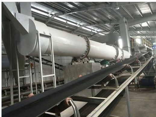
图 4. 复合肥用滚筒造粒机
