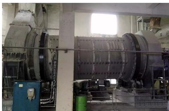
图 5. DAP 用的喷浆滚筒造粒机
