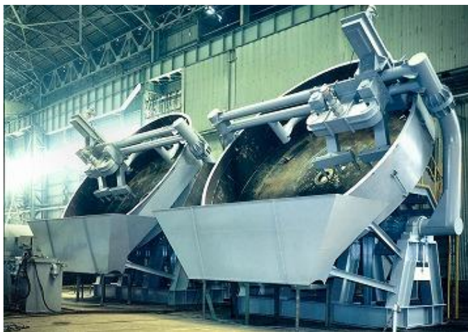
图 2. 实际使用中的圆盘造粒机
