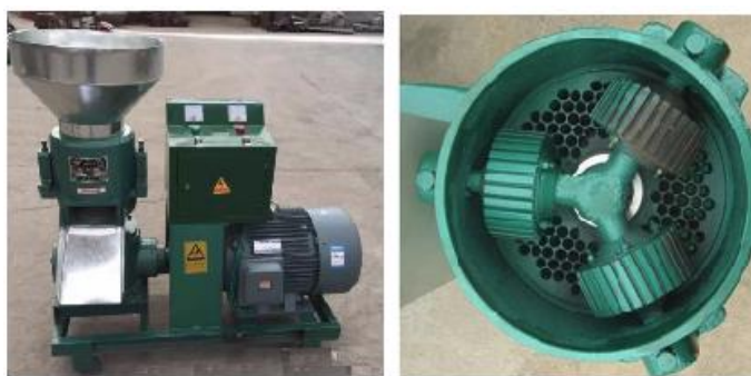
图 7. 辊轮挤出造粒机（左：机体，右：挤压辊轮）
