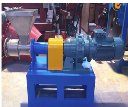
图 6. 螺旋挤出造粒机
