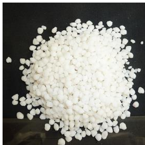
图 4. 氯化铵的挤压颗粒（粒径 3~5mm）
