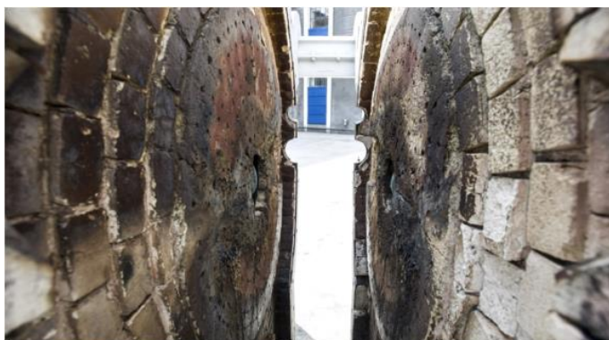
図3. 窒素固定用放電装置 図4. 放電装置内部の電極固定円盤(表面の焼け跡は放電跡)
