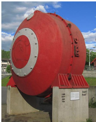
図3. 窒素固定用放電装置 図4. 放電装置内部の電極固定円盤(表面の焼け跡は放電跡)
