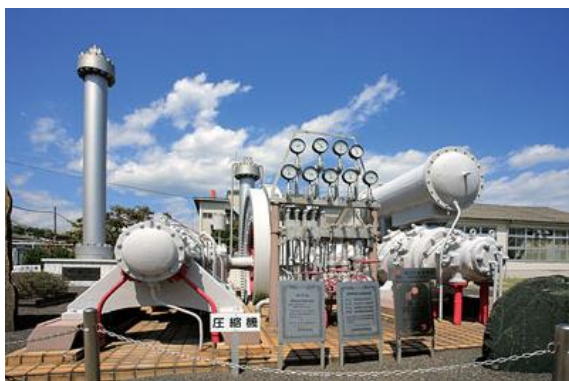
図1. 延岡工場のカザレー法アンモニア合成装置
