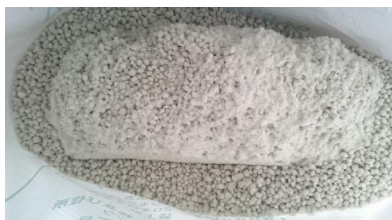
図 2. 荷重による硫安ブリケット品の偽似固結
