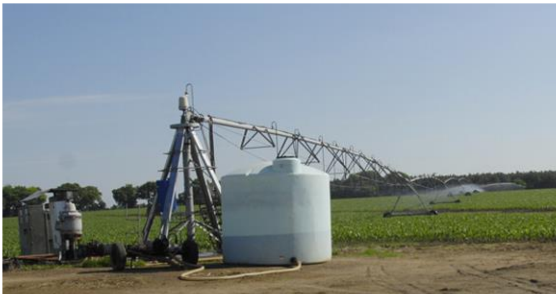
図 5. センターピボット灌漑システムの液肥タンク
