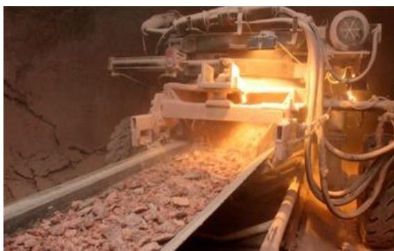
写真 5. パンツァーコンベアーでの輸送
