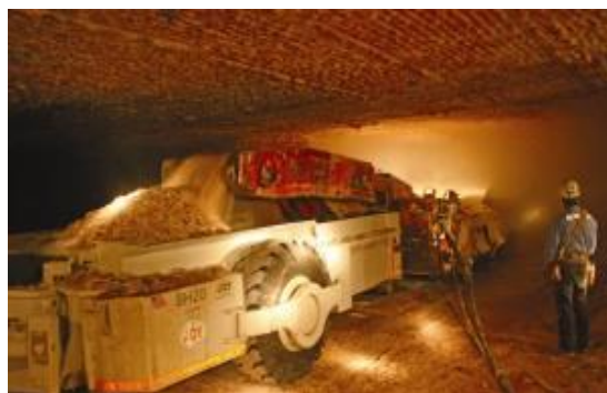
写真 4. コンテナスマイナでの採鉍
