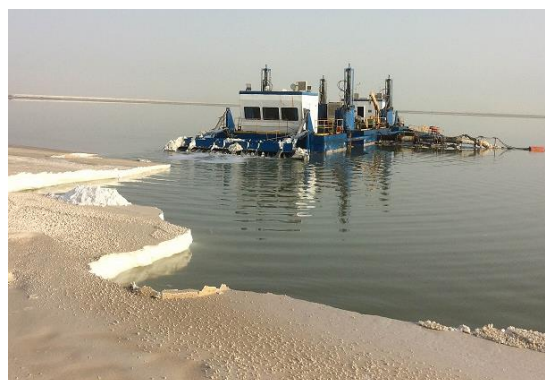
図 8. 蒸発池からカーナリットの回収
