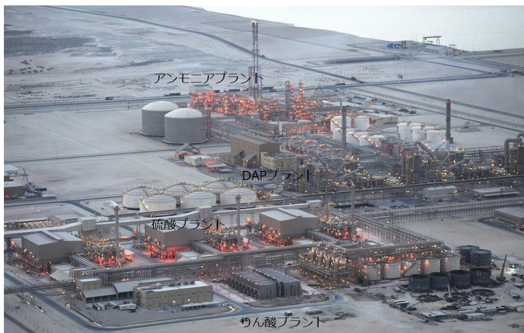
図 5. Ras Al Khair りん酸肥料工場の全景と各プラントの位置
