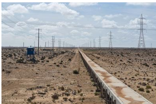
図 11. りん鉱石を運ぶベルトコンベア
