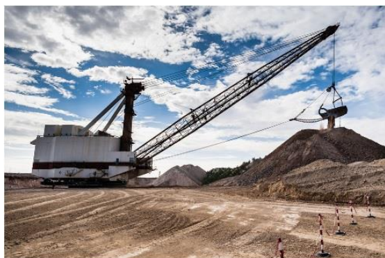
図1. 機械で表土層の除去
