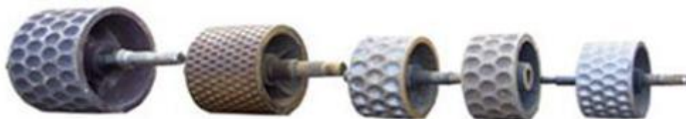
図 9. 種々ブリケット造粒機のロールとダイキャビティ写真 (主に豆炭や金属回収屑、焼却灰の造粒に使う)
