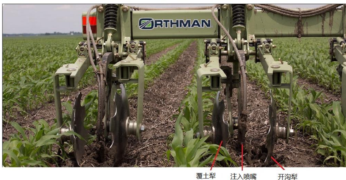
图 4. 液体肥料专用施肥机的肥料注入部构造
