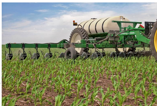
图 2. 液体肥料专用施肥机在玉米地的施肥作业
