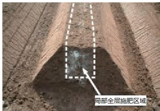
图 2. 起垄施肥机起垄施肥后的肥料分布状态
