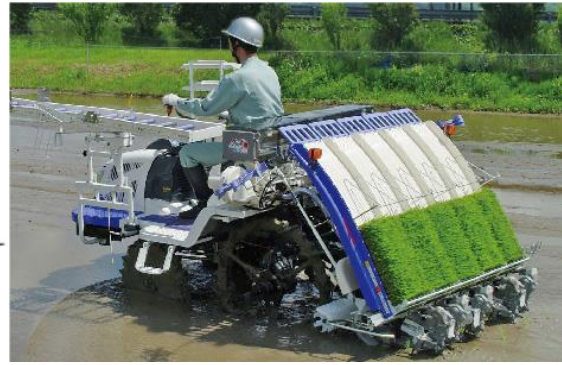
图 2. 三菱农机公司的侧条施肥机的作业相片
