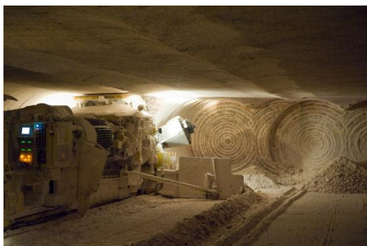
写真 4. ドラムカッターでの採鉍 (カナダ Potash Corp)
