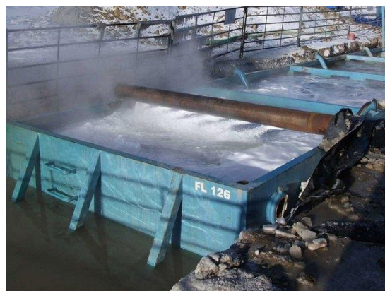
写真9. 溶解採鉱法により抽出された鹹水 (カナダサスカчевン州)
