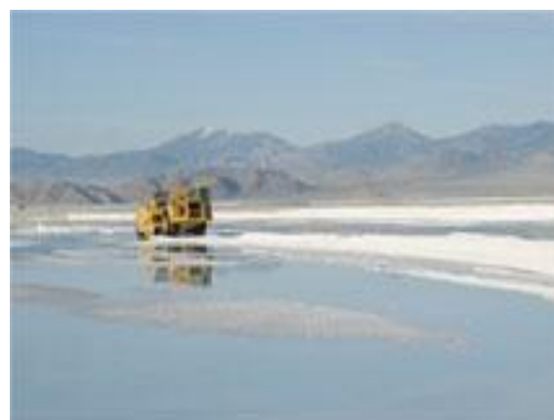
写真 13. グレートソルト湖の採塩池にハーベスターがカーナリット結晶を集める
