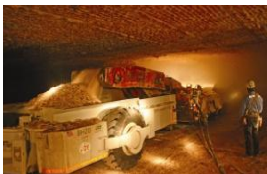
写真 5. コンテナスマイナでの採鉍 (カナダ Potash Corp)
