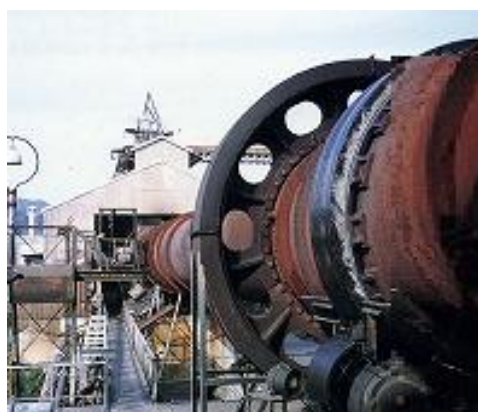
图 4. 日本小野田化学的烧成磷肥用的回转炉
