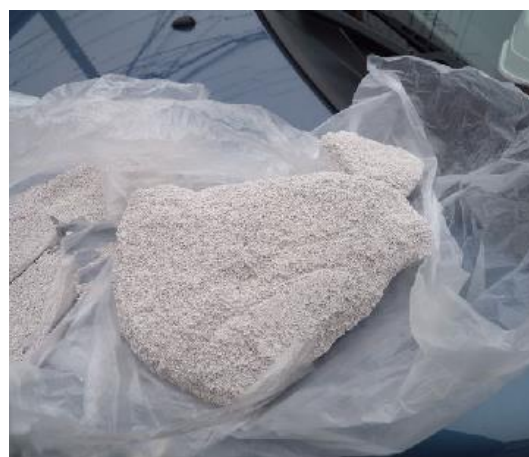
図 4. 流通過程の破袋による化成肥料の固結
