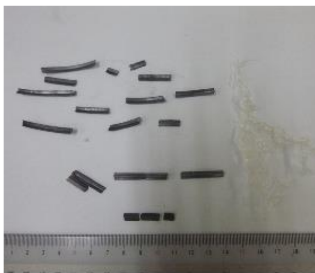
図1. 球状硝酸加里生産工程に混入した金属破片 (製品篩分け用の篩の一部)
